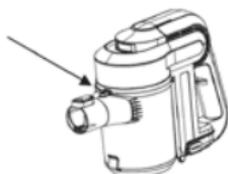
Sie können den Staubbehälter wieder einsetzen, indem Sie die Schritte in umgekehrter Reihenfolge befolgen und den Staubbehälter in entgegengesetzter PFEILRICHTUNG drehen.
