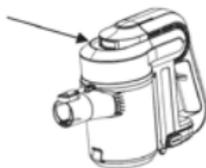
Кнопка открытия-закрытия крышки фильтра HEPA
